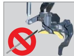
Bec de montage / démontage sans levier (breveté) Mounting / demounting without lever (patented)
