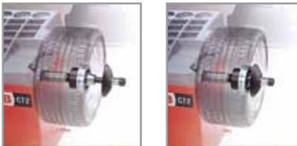
Mécanisme de blocage pneumatique de la roue.
