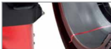
Faisceau laser pour positionner précisément les pesées adhésives à 6h.
