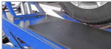
Verrouillage pneumatique au centre de la plaque coulissante Central pneumatic locking of the sliding plate
