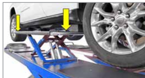
La table élévatrice a une double extension: une à l'avant et une à l'arrière.
