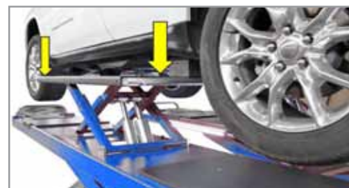
La table élévatrice a une double extension: une à l'avant et une à l'arrière. The lift table has a double extension: one on the front and one on the rear.
