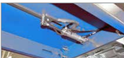
Verrouillage pneumatique au centre de la plaque coulissante Central pneumatic locking of the sliding plate
